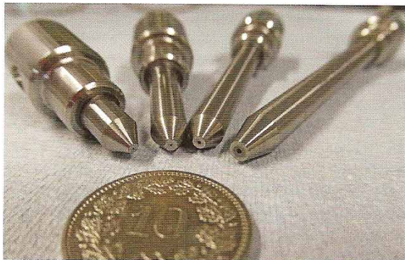
Der Schneidkopf kann Strahldurchmesser von 0,2, 0,3, 0,5 oder 0,8 mm erzeugen
